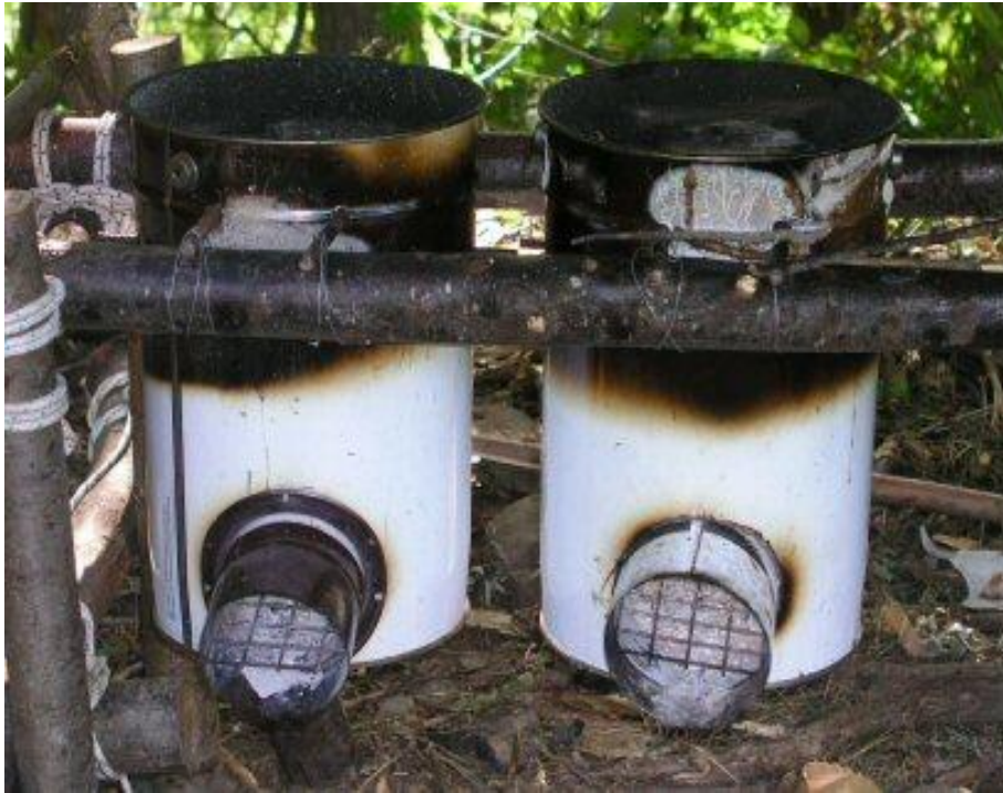
Foto dei due fornelli della Sq. Pantere, si nota la vernice bruciata dove non arriva il livello dell'isolante. Qui sotto la visione d'insieme della cucina, con i due fornelli turbo montati.
