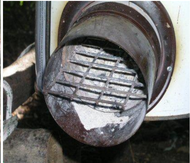
Foto dell'imbocco del bruciatore, dove si nota la grata su cui viene inserita la legna
